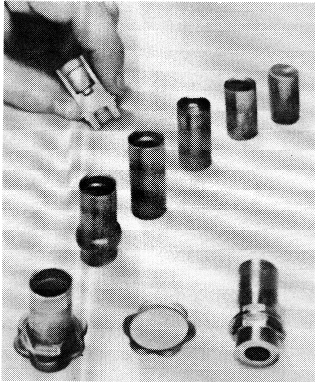
Figuur 10.11: Een voorbeeld van een koudextrusie-proces in zeven stappen
