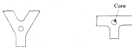
Figuur 2.11: Voorbeelden van de toepassing van kernen om materiaal-opeenhoping te verminderen.
