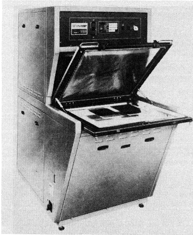
Figuur 17.6: Een UV-belichtingseenheid met twee 2 kW-lichtbronnen
